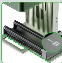
An der Markierungslinie 2 ausrichten
