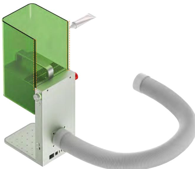
■ Wenn aus der Schutzumkleidung Rauch entweicht, sind möglicherweise das Gebläse und der Rauchausslass aufgrund von Staub verstopft. Reinigen Sie sie, um eine ordnungsgemäße Rauchabsaugung sicherzustellen.
